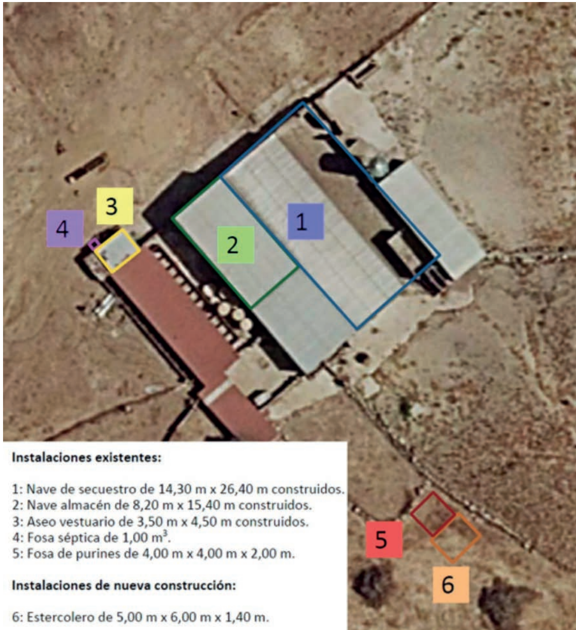
Fig. 1. Planta general de las instalaciones.
